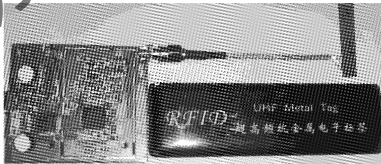
图 5-4 高频读写器模块与抗金属标签
