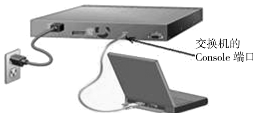
图 3.8 计算机与交换机通过 console 端口连接
