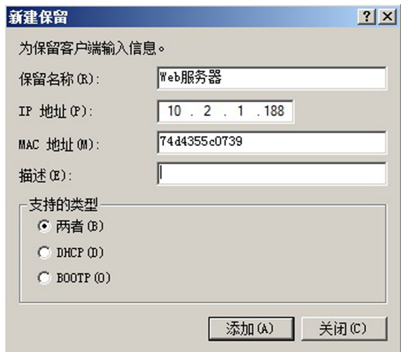
图 5-34 添加 IP 地址及其对应的 MAC 地址
