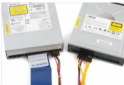
图 2-36 连接光驱数据线（左：IDE 接口 右：SATA 接口）
