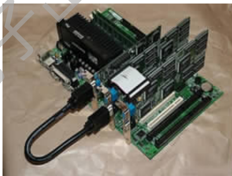
图 2-15 SLOT1 插槽上插着 Pentium II 处理器芯片
