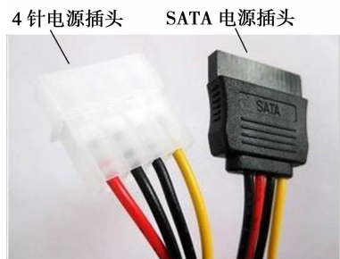
图 2-33 两种电源插头对比图
