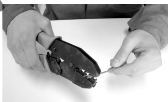
图 1-46 冷压端子的压接
