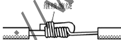
图 1-54 不同截面单股电线的直接连接
